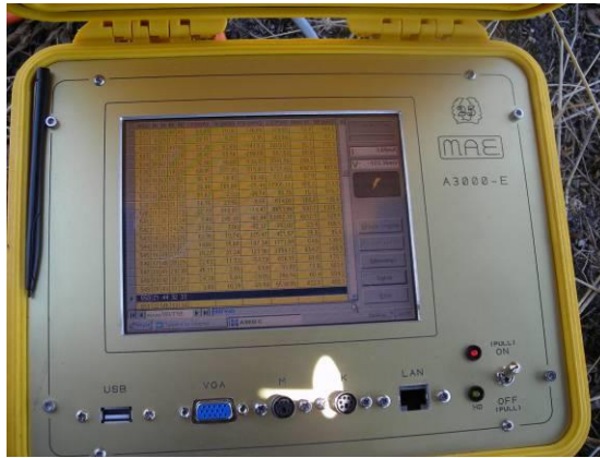
Fig. 4 – Georesistivimetro MAE A3000E.
