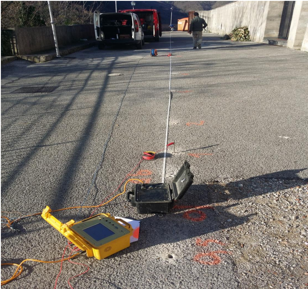
Fig. 3 – Documentazione fotografica indagine geoelettrica effettuata.
