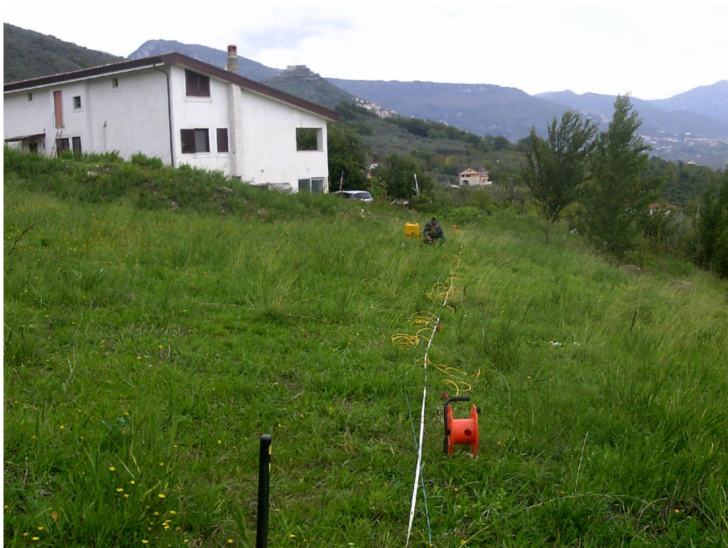
Fig. 4 - Foto indagine Masw via Calabriso – Giffoni Sei Casali (SA)
