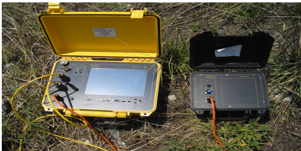
Fig. 1 – Sismografo M.A.E. A6000-S utilizzato per le indagini effettuate.
