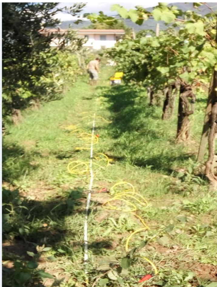
Fig. 4 - Foto indagine Masw loc. ...., – Giffoni Sei Casali (SA)
