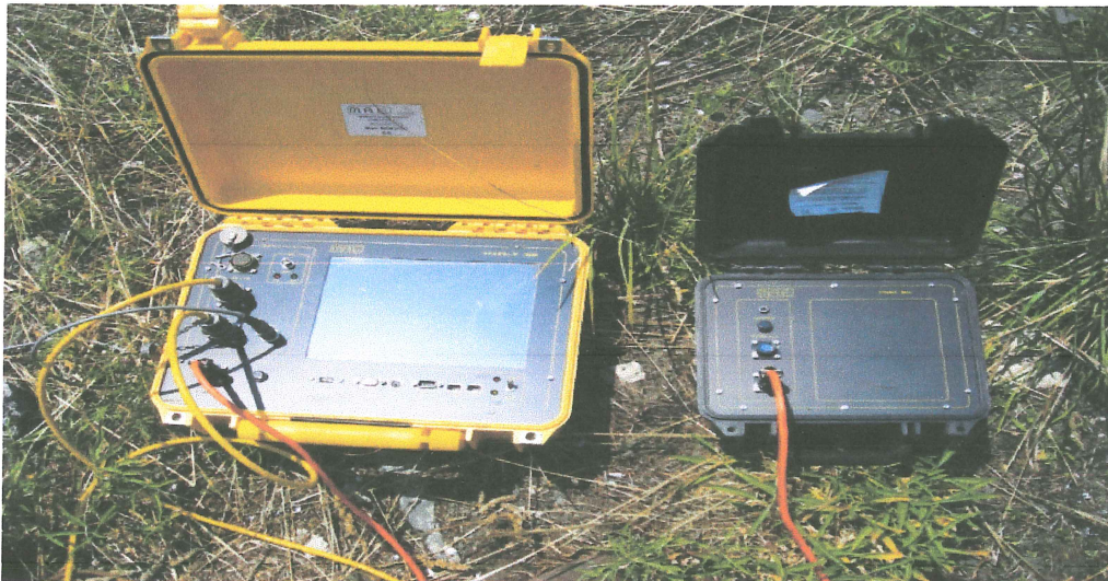
Fig. 1 – Sismografo M.A.E. A6000-S utilizzato per le indagini effettuate.
